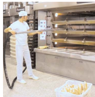
Pulizia dei forni tramite apposita scopa collegata ad una presa di aspirazione.
